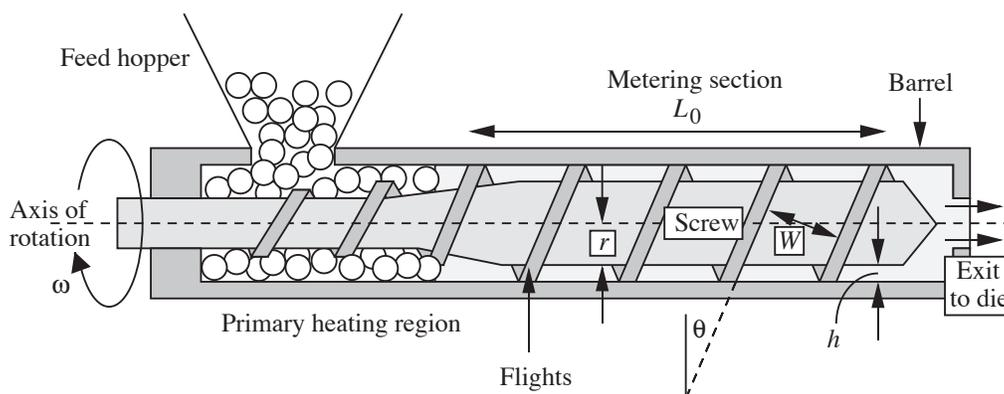
Fig. E6.4.1 Screw extruder.
