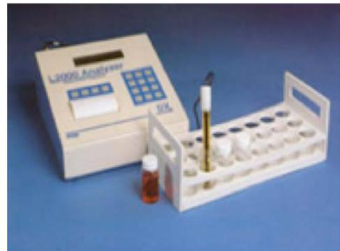
Figure A-9. L2000 PCB/Chloride Analyzer ([www.dexsil.com](http://www.dexsil.com)).
